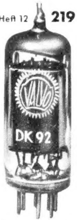
Bild 1. Die neue Batterie-Mischröhre Valvo DK 92 in 7-Stift-Allglas-Ausführung
